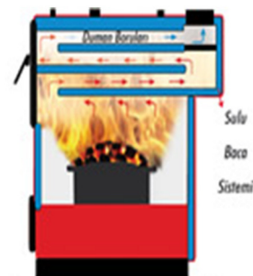
Atmosfere çıkan baca gazı sıcaklığından maksimum faydayı sağlayan 4 geçişli ve sulubazlı sistem
